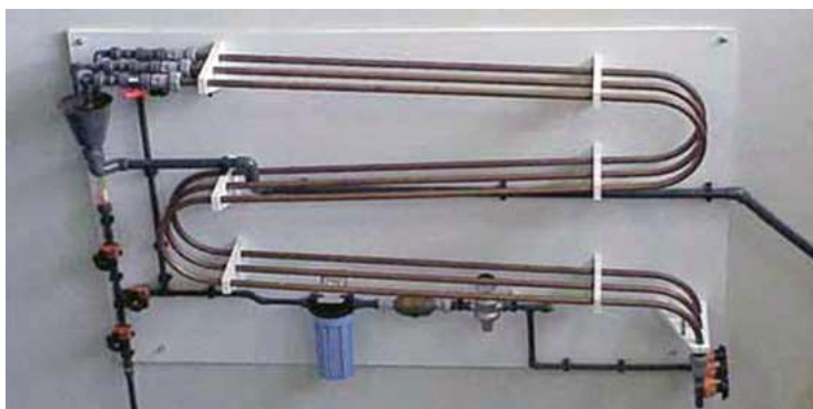
Proefopstelling op een zuiveringsstation van Oasen om koperoplossend vermogen van water te meten
